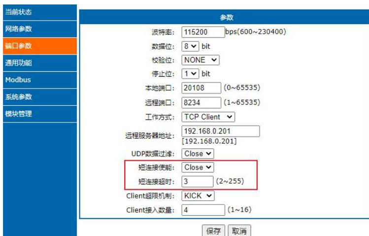
图 11. 短连接设置图示
