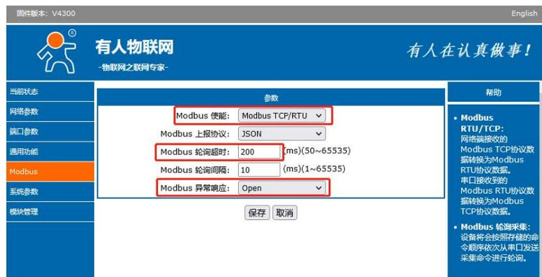
图 20. Modbus 协议转换功能设置
