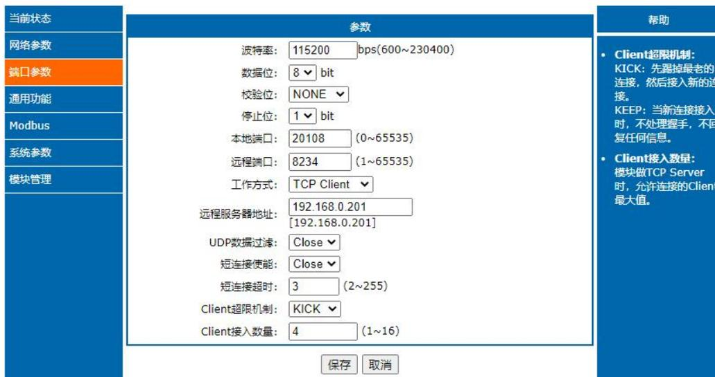
图 8. 端口参数
