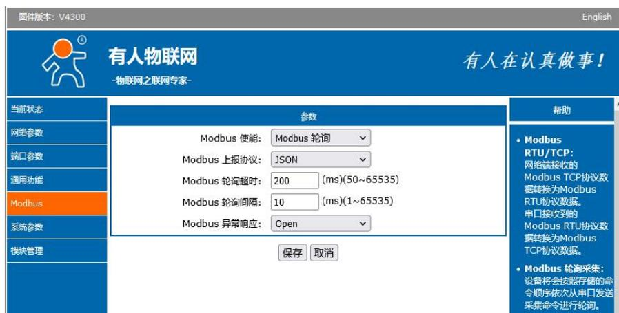
图 23. Modbus 协议轮询采集功能设置
