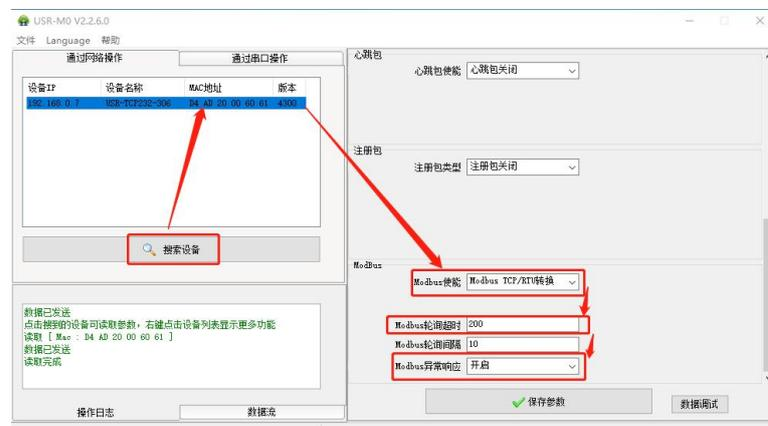
图 21. 软件设置 Modbus 协议转换
